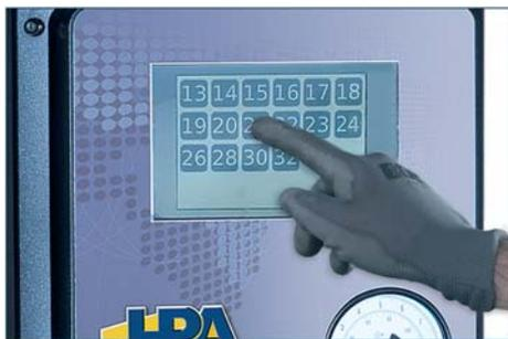
Impostazione dimensione ruota in pollici (13" ÷ 32") ed autoposizionamento radiale ottimale della stessa rispetto al "revolver" automatico.
