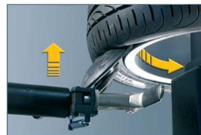
Successivamente, il disco stallonatore inferiore preme da sotto e la contemporanea rotazione della ruota facilita la stallonatura inferiore.
