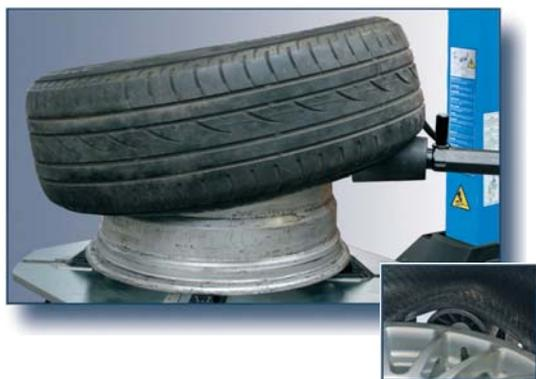
**Rullo conico.** Facilita le operazioni di smontaggio e montaggio primo tallone, mantenendo il tallone nel canale del cerchio. Agevola la fase di smontaggio del secondo tallone.
