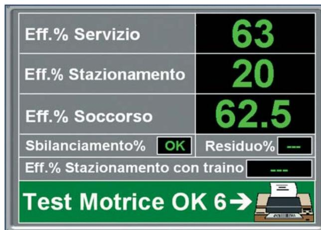
MISURA EFFICIENZA FRENANTE dei dispositivi di azionamento degli impianti frenanti.
