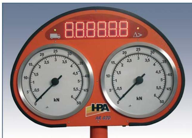
AR 420. Ripetitore analogico delle misure del banco prova freni.
